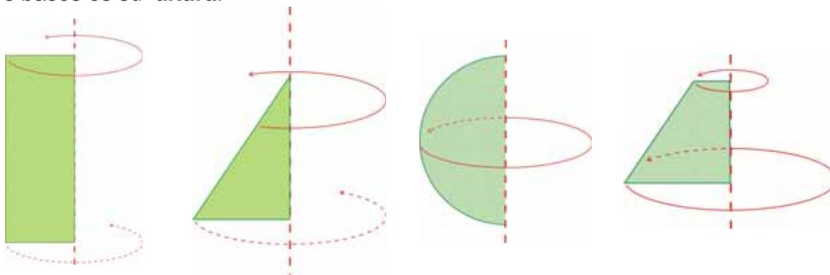
El **cono** es el cuerpo que se obtiene al hacer girar un triángulo rectángulo alrededor de un eje que contenga a uno de sus catetos. La intersección del eje con la hipotenusa da lugar al **vértice del cono**, el círculo generado por el otro cateto es la **base del cono**, la medida del cateto que está sobre el eje de giro es la **altura del cono** y la hipotenusa la **generatriz**.
