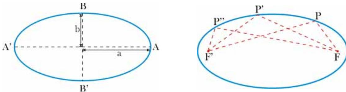
La elipse tiene dos **ejes de simetría**, AA' y BB' que se cortan perpendicularmente en sus puntos medios. La medida del eje mayor, AA', es **2a** y la del eje menor, BB', es **2b**. Los puntos A, A', B y B' son los **vértices** de la elipse.
